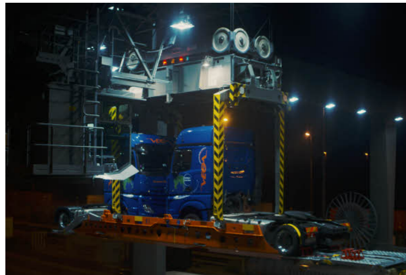
Zwei Sattelzugmaschinen geladen auf r2L Transport-Technik, kurz vor der Beladung in einen T3000 Waggon.
