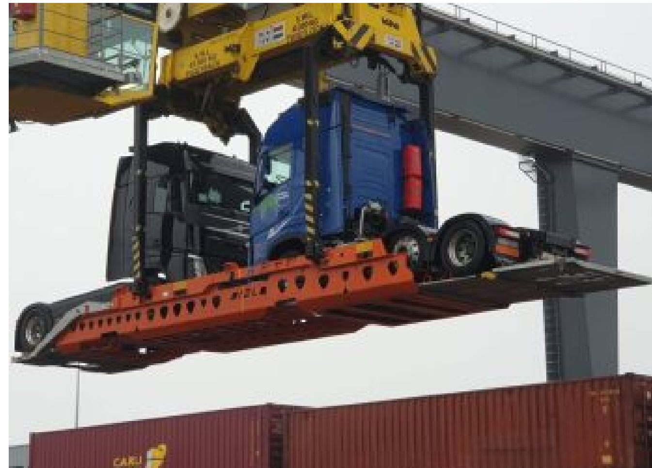
Grüne Transportlösung aus Salzburg: Zwei Sattelzugmaschinen werden mit der innovativen r2L Technik auf die Bahn geladen. BILDER: SN/VEGA (2)
